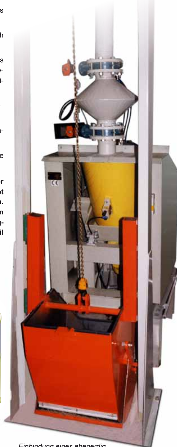
Einbindung eines ebenerdig aufgestellten PKM Mixers in das Behältertransportsystem HLK
