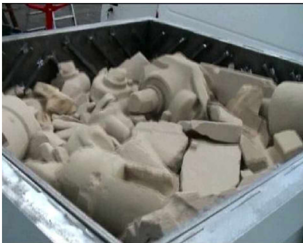
Abb.1: Blick in den Raspeltopf mit Kernbruch
