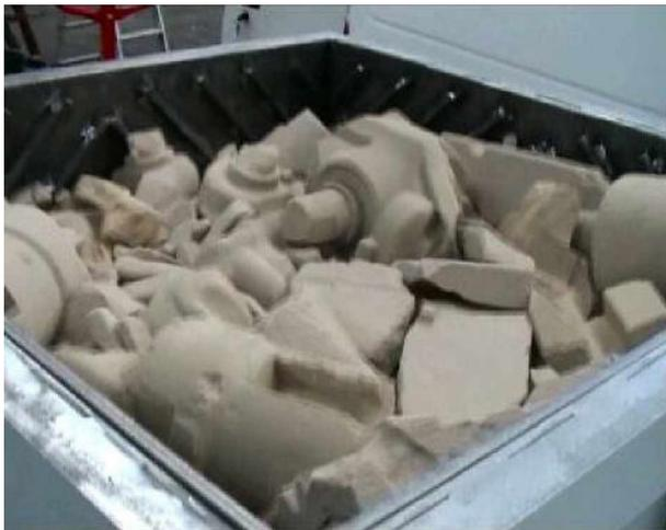
Рис.1: Вид на рашпильную емкость с разрушенными стержнями
