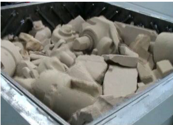
Photo 1: Vue du pot à vibration avec résidus de noyaux
